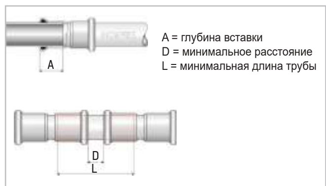
Рис. 27. Глубина вставки и минимальные размеры.
